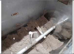
So sieht die Maschine innen aus: Sie besitzt eine drehende Achse mit versetzten Schaufelspeichen, die das Material durchmischen. Die Mischung wird angeheizt und ist mit einem speziellen Mikrobenbesatz beimpft.
